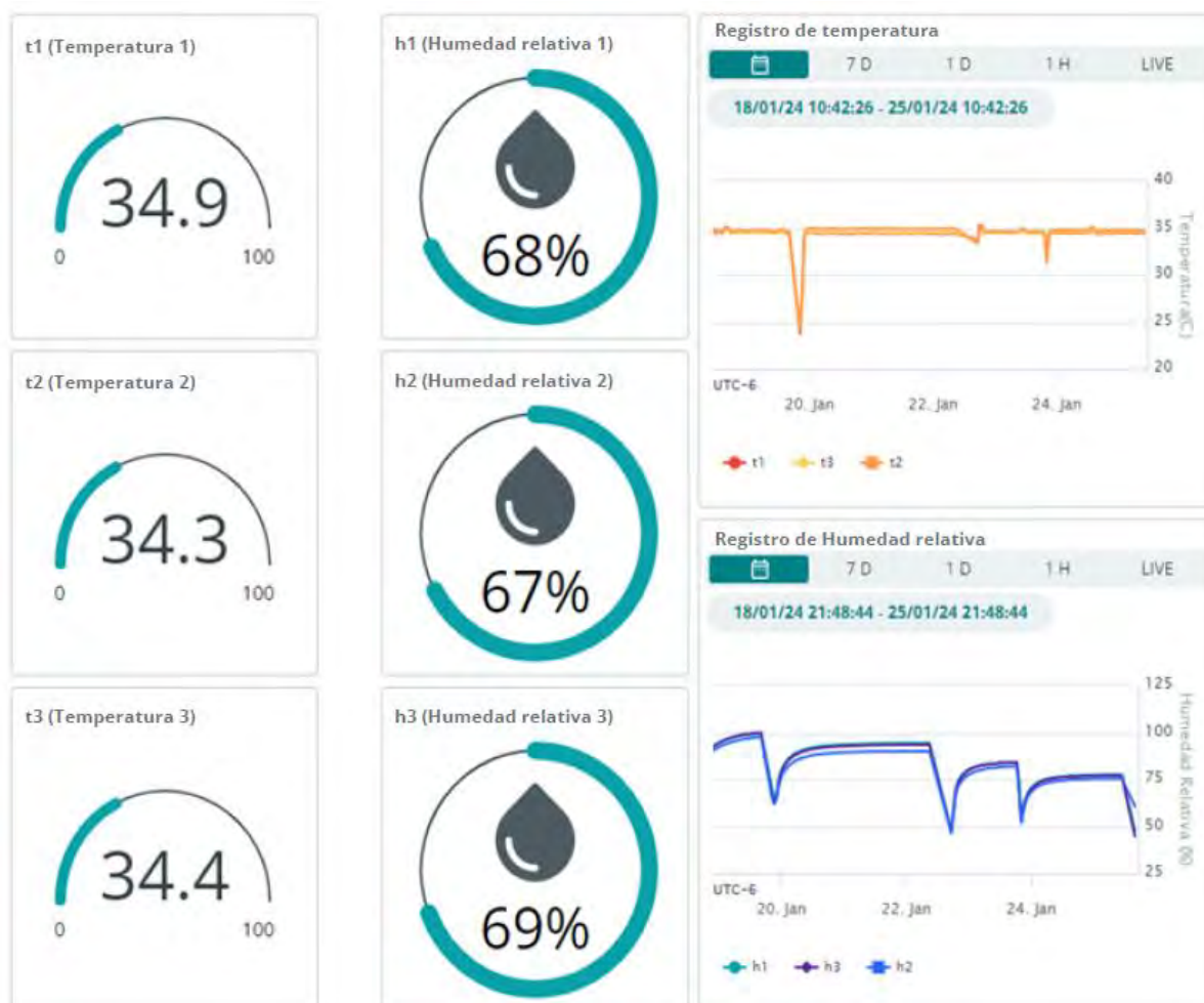
Figura 9. Diseño del panel web para visualizar las condiciones de almacenamiento de los granos de café miel registradas por tres sensores DHT-21.
