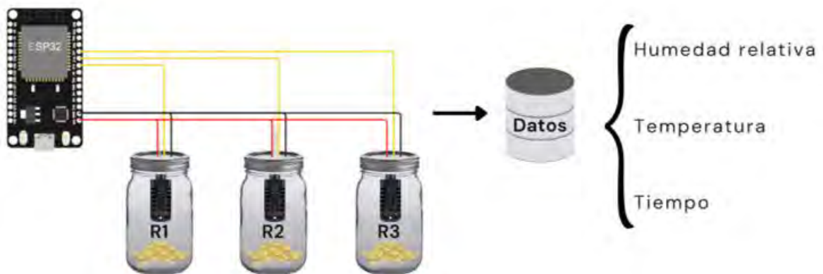
Figura A.3. Diagrama del prototipo IoT para el monitoreo de la humedad relativa y temperatura de almacenamiento del café miel.
