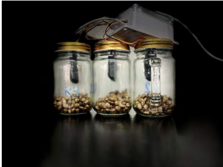
Figura 12. Prototipo IoT para el registro de los datos de la humedad relativa y temperatura del aire en contacto con los granos de café miel.
