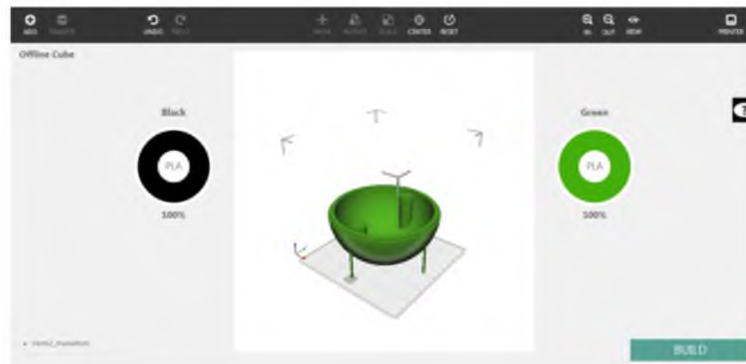
Figura 2. 1 Copia de salida del software Cube 3D y visualización de una de las piezas de la esfera diseñada.
