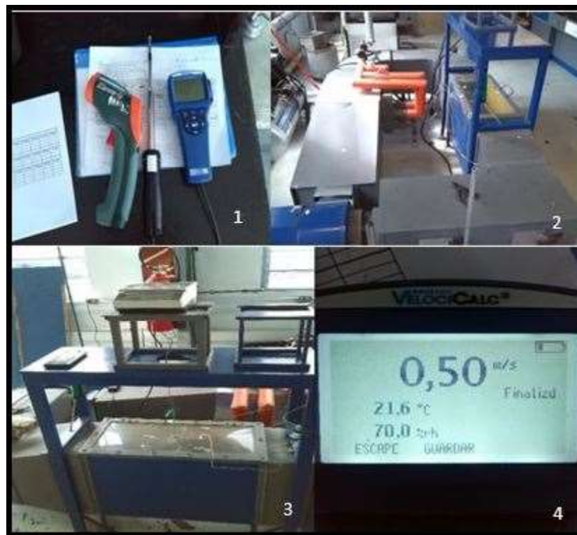
Figura 4. Metodología utilizada en el ensayo 3. (1)Termoanemómetro y termómetro infrarrojo, (2) Túnel de secado, (3) Balanza granataria conectada al sistema de secado, (4) Termoanemómetro.
