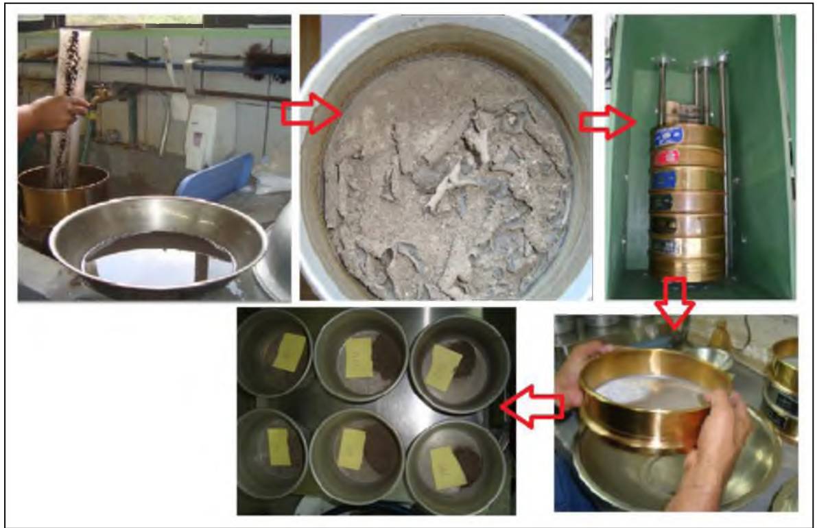
Figura 8.13. Procedimiento para realizar análisis granulométrico con tamizado
