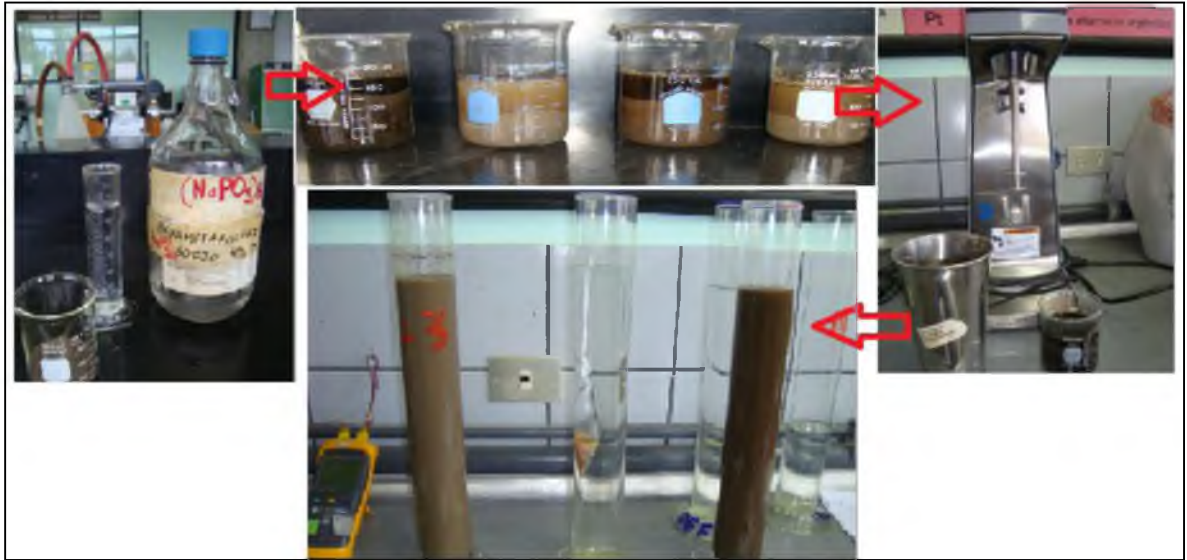
Figura 8.12. Procedimientos para análisis granulométrico por el método del hidrómetro
