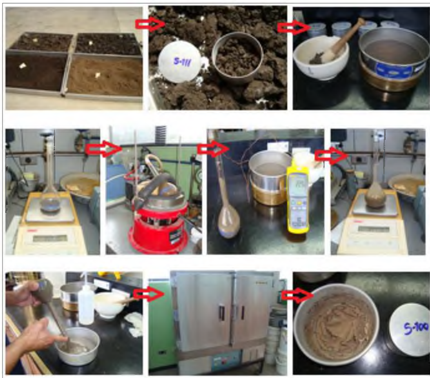
Figura 8.9 Procedimiento de la norma ASTM D-854
