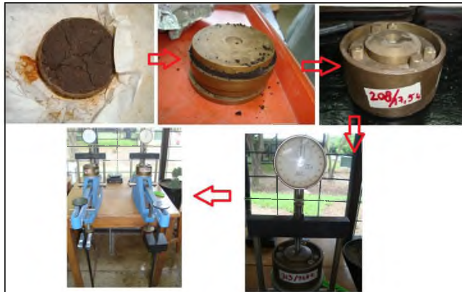
Figura 8.21. Procedimiento para realizar curva de consolidación
