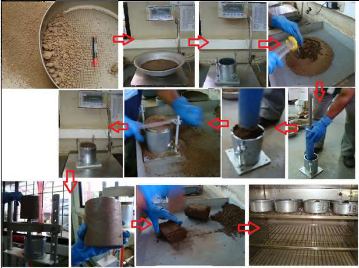
Figura 8.22. Procedimiento para prueba Proctor Estándar
