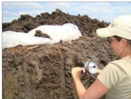
Figura 3.4 Toma de datos de Resistencia a la penetración utilizando el Penetrómetro
