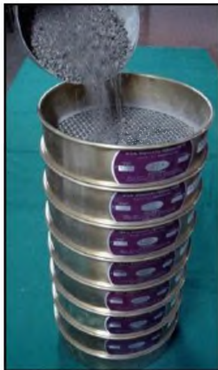
Figura 8.13. Procedimiento para realizar análisis granulométrico con tamizado
