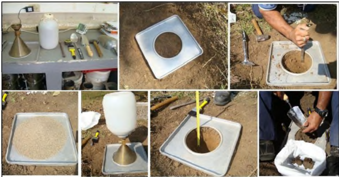
Figura 8.23. Determinación de la densidad del suelo utilizando el método del cono de arena
