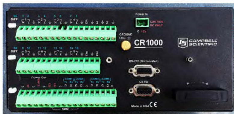
Figura 27. Dispositivo de Adquisición de Datos (DAQ), modelo CR1000 de Campbell Scientific, utilizado en este proyecto para registrar datos de temperatura.
