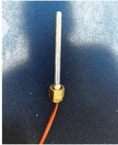
Figura 28. Termopares tipo K utilizados para medir la temperatura del fluido y del sustrato en el digester anaeróbico termofílico.
