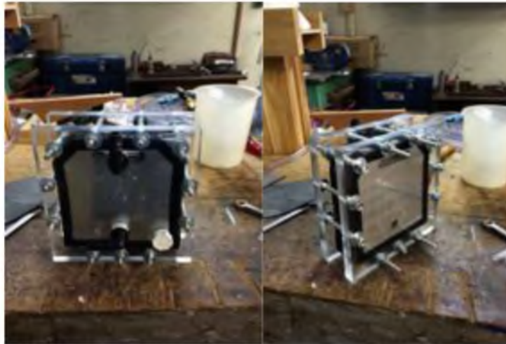
Figura 2. 16. Celda electrolítica terminada.
