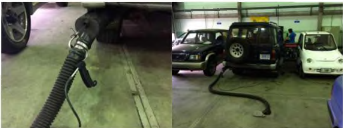
Figura 3. 8. Conexión de la sonda a la salida del escape.
