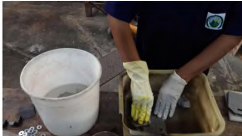
Figura 2. 6. Limpieza de placas con ácido acético.
