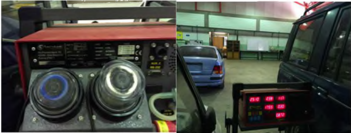
Figura 3. 7. Analizador de gases Tecnotest 488 .
