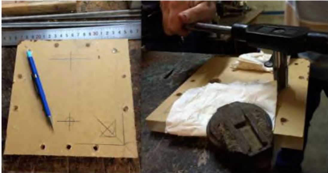
Figura 2. 11. Marcado y perforación del acrílico frontal.
