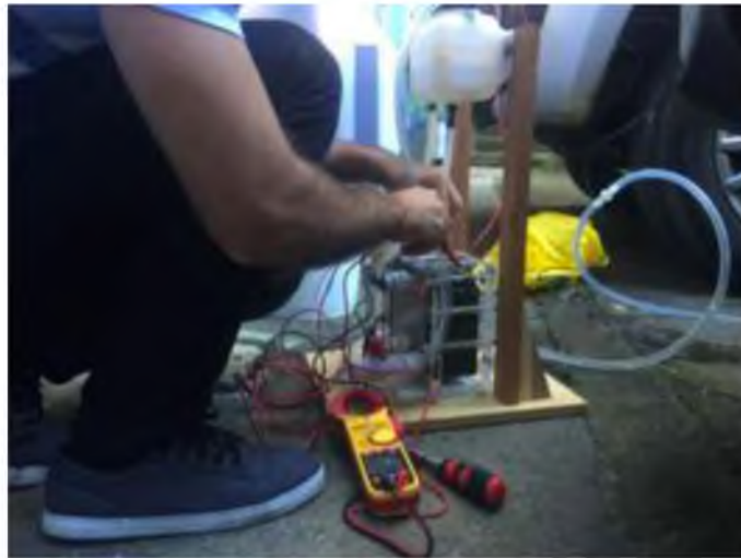
Figura 3. 1. Medición de voltaje entre celdas adyacentes.
