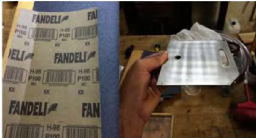
Figura 2. 5. Placa limada y lijada, lista para el lavado.
