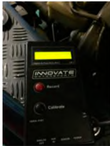
Figura 3. 3. Medidor digital de relación Aire/Combustible de la marca Innovate Motorsports modelo LM-1.
