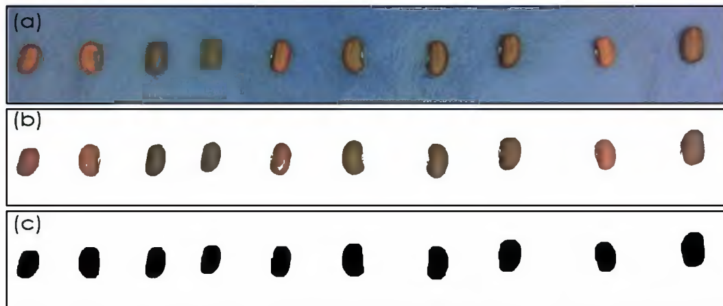
Figura 13. Segmentación de las pruebas realizadas con las semillas, obtenida con el software ImageJ para frijol rojo. (a) Imágenes obtenidas de la cámara, (b) Segmentación por color, (c) Binarización y aplicación de morfología binaria.
