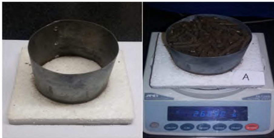
Figura 19. Determinación de densidad aparente en pellets.
