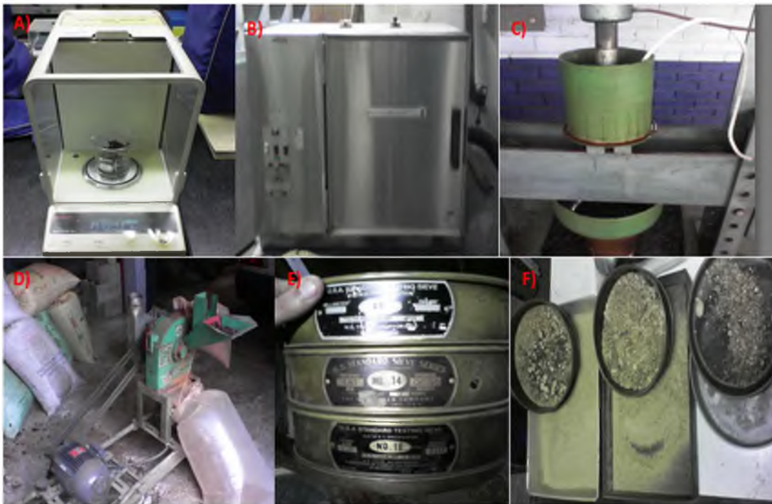
Figura 14. Equipos utilizados en el pretratamiento de biomasa.
