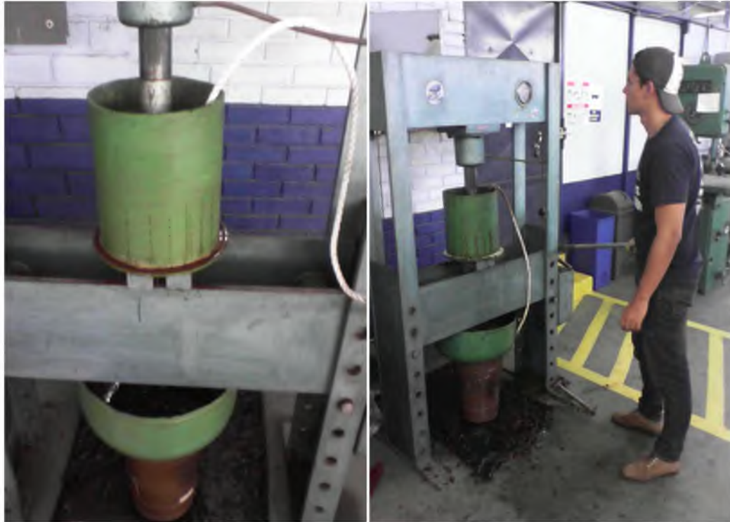
Figura 12. Prensado mecánico de broza de café.
