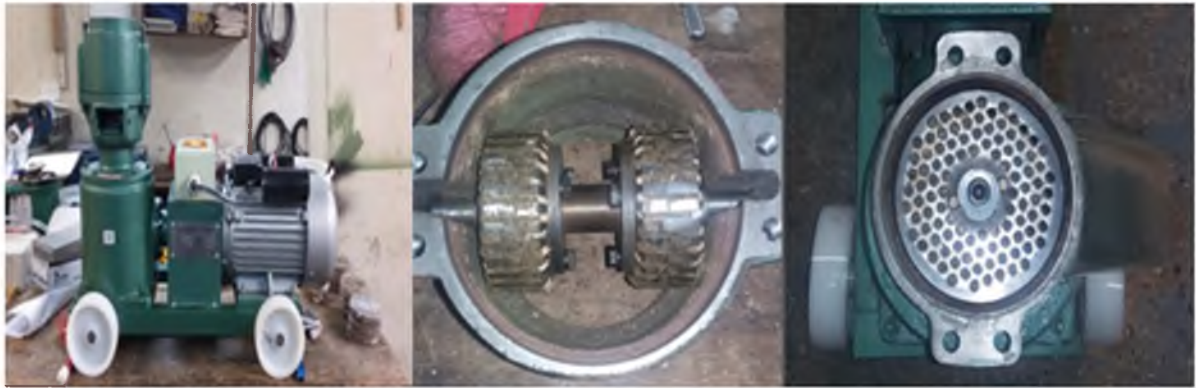
Figura 5. Pelletizadora de rodillos y sus componentes
