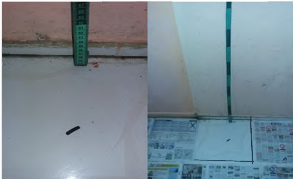
Figura 21. Determinación de la friabilidad en pellets.
