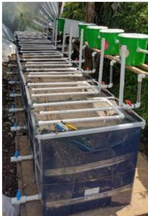
**Figura 15.** Sistema de tubería de PVC para la aplicación de riego en los humedales piloto.
