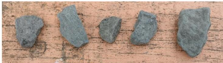
**Figura 25.** Muestra de piedras de río utilizadas como sustrato de tres unidades de humedales piloto.
