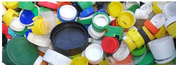
**Figura 23.** Tapas plásticas de distintos tamaños utilizadas como sustrato en tres unidades de humedales piloto.
