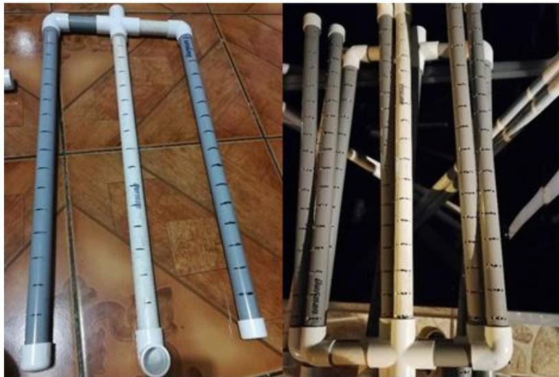
**Figura 11.** Distribución de orificios en tubería de drenaje para humedales piloto.
