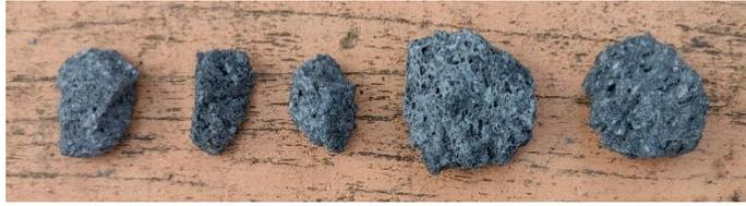
**Figura 24.** Muestra de rocas volcánicas utilizadas como sustrato en tres unidades de humedales piloto.
