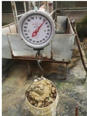
**Figura 19.** Medición del peso de las excretas recolectadas con barrido en seco.
