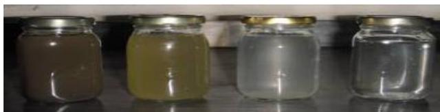
**Figura 27.** Agua de salida de cada subsistema. De derecha a izquierda: agua de entrada, agua de salida del humedal 1, agua de salida del humedal 2 y agua de salida del humedal 3 (Gómez et al., 2010).
