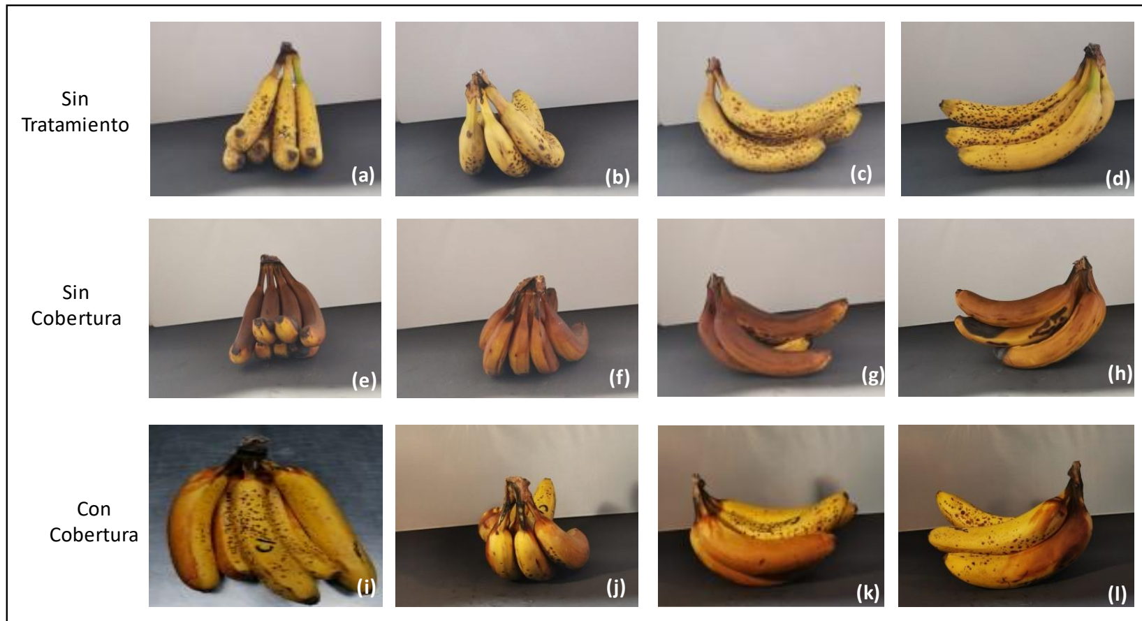
Figura 4-4. Prueba preliminar de cobertura de las manos de banano, (a)-(d) vistas de los perfiles de manos sin tratar, (e)-(h) vistas de los perfiles de manos tratadas sin cobertura, (i)-(l) vistas de perfiles de manos tratadas con cobertura.
