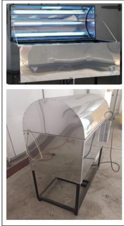
Figura 2-3. Cámara de radiación UV-C (modelo GR30T8 Techno Lite) [9].
