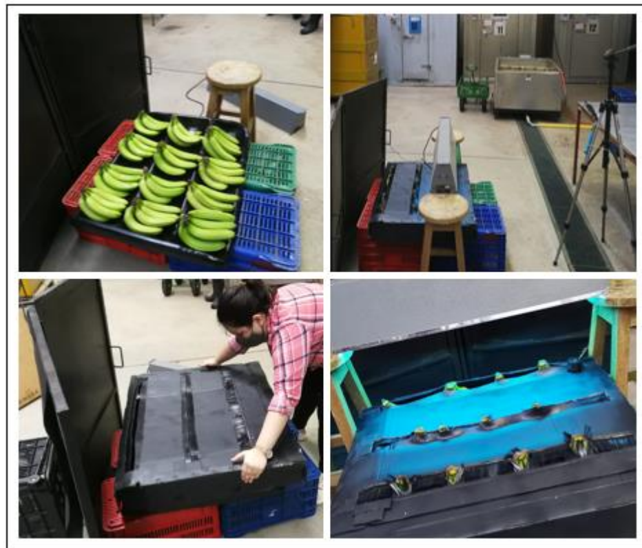
Figura 4-7. Montaje de tapa de protección para prueba de coberturas.
