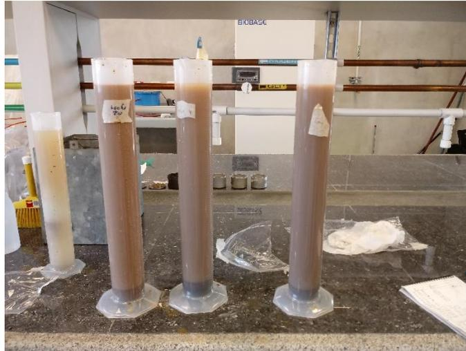
Figura 67. Prueba de Bouyoucos para la muestra en el lecho del río a 20 cm, en la etapa de separación de sedimento.
