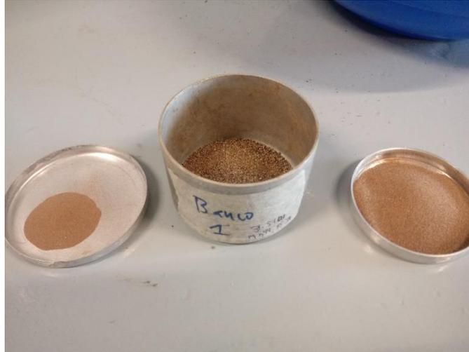
Figura 69. Muestra de suelo de Banco 1 después del último secado en la prueba de granulometría posterior al tamizado para ser pesado.
