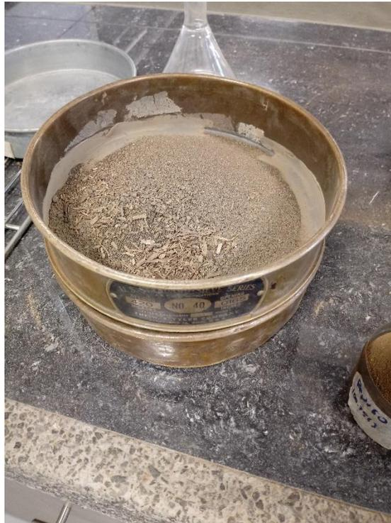
Figura 70. Muestra de suelo retenida en el tamiz No. 40 en el proceso de tamizado.
