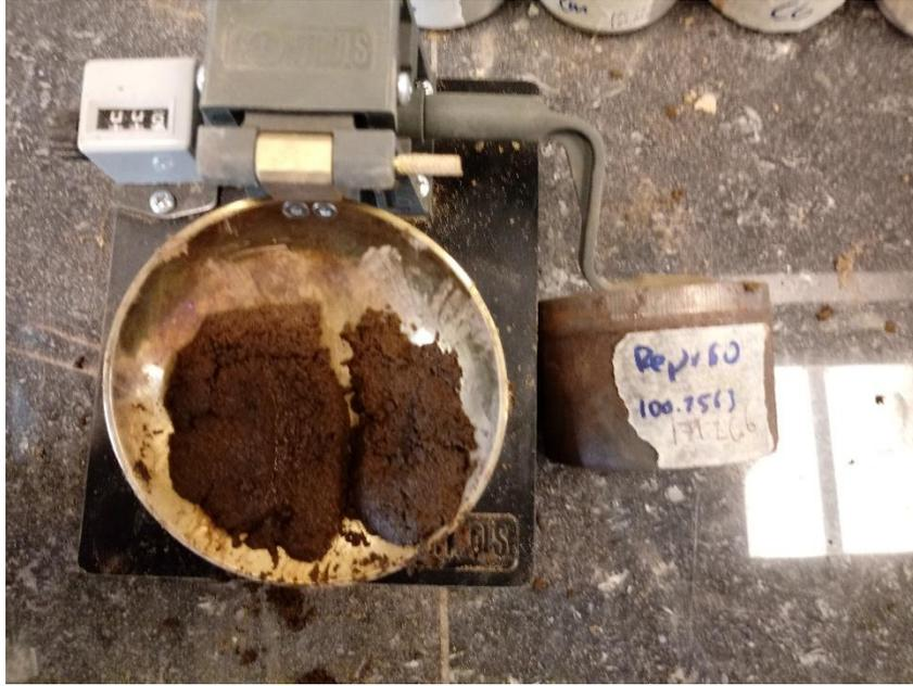
Figura 71. Prueba de límite de Atterberg para la muestra en planicie de inundación de la represa a 60 cm de profundidad.
