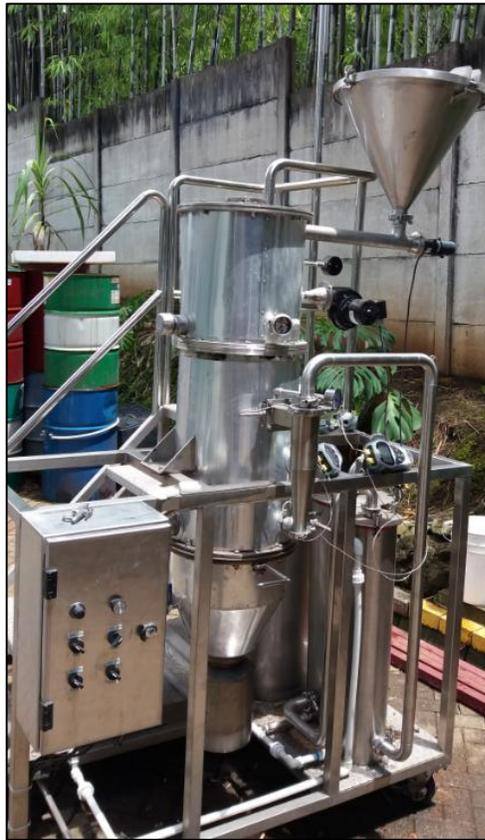
**Figura 2.1.** Reactor de gasificación de flujo concurrente.
