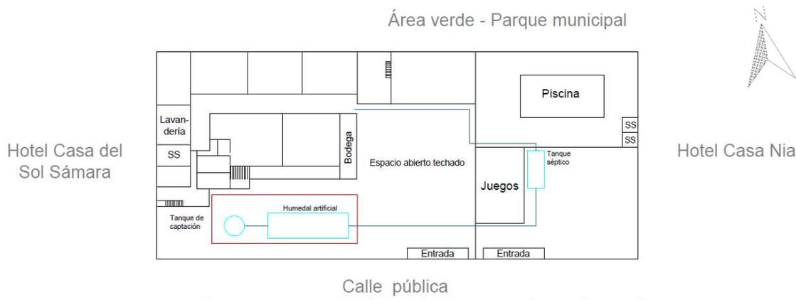
Figura 23. Disposición recomendada del sistema de tratamiento de aguas residuales para el HPPS.
