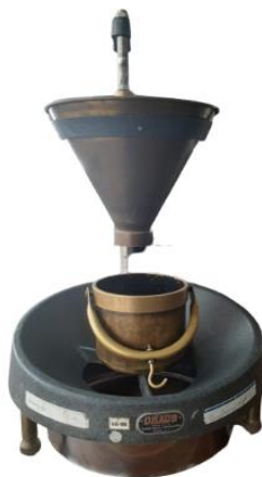
Figura 8. Equipo para la medición de la densidad aparente por el método de caída libre.
