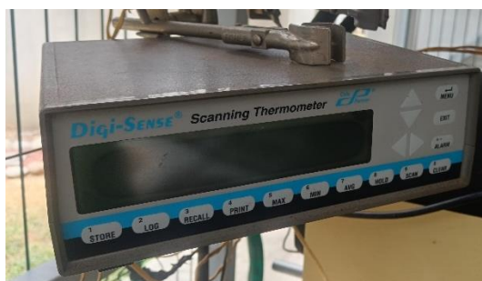
Figura 6. Escáner y termopares para la medición de la temperatura interna del tostador.
