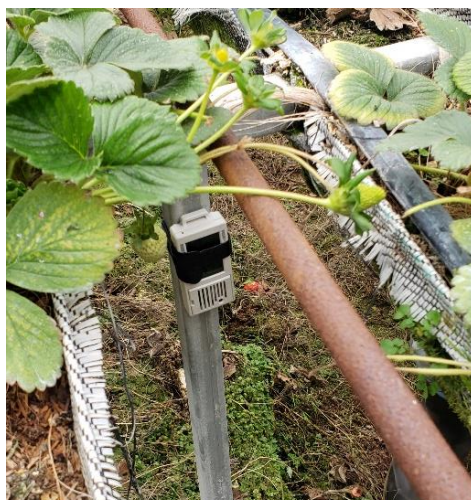
Figura 10. Ubicación de los sensores HOBOT a la altura de las plantas.
