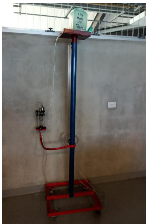
Figura 6. Permeámetro marca Karon Warner del Laboratorio de Suelos y Aguas de la Escuela de Ingeniería de Biosistemas.
