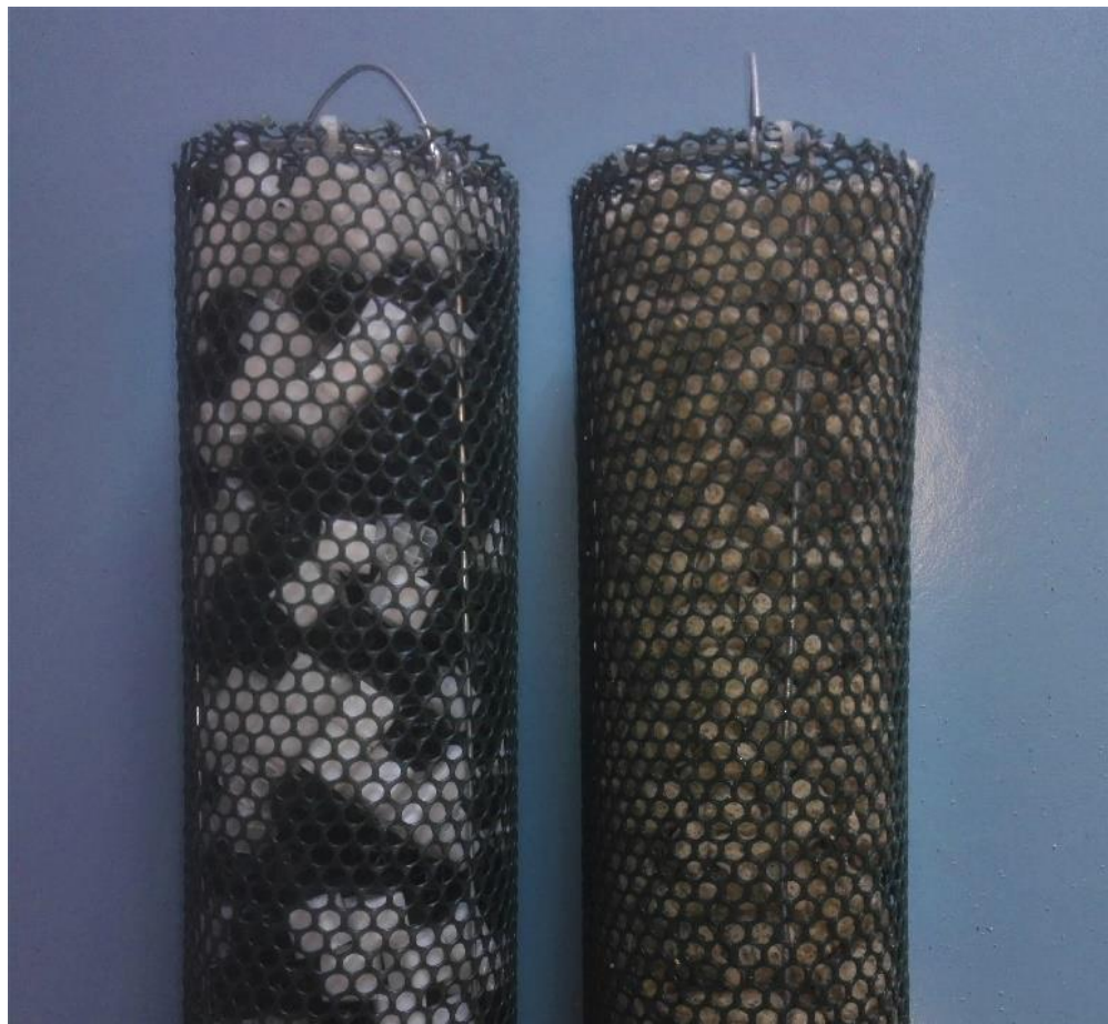
Figura 16. Sostén del material de capa fija en el interior de cada filtro. A la izquierda mezcla plástica de filtro 1, a la derecha piedra pómez de filtro 2
