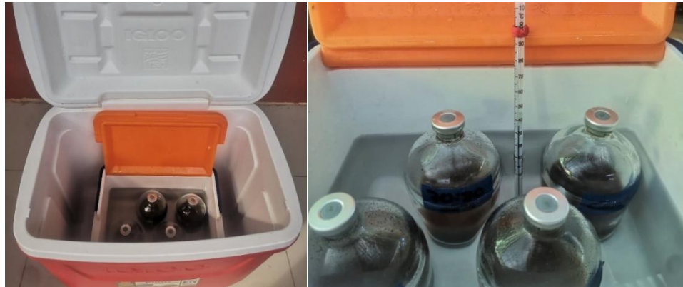
Figura 10. Ensamble de ensayo BMP con incubadora, a) almacenaje de las muestras, b) control de temperatura en baño maría
