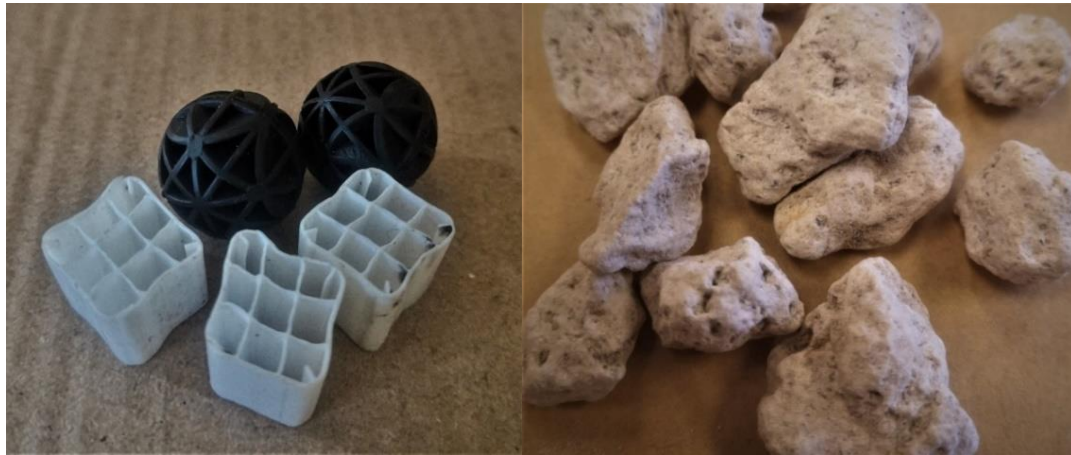
Figura 8. Material de lecho fijo del interior de los filtros: a) soportes plásticos y b) piedra pómez
