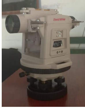
Figura 6. Tránsito utilizado para levantamiento de niveles
