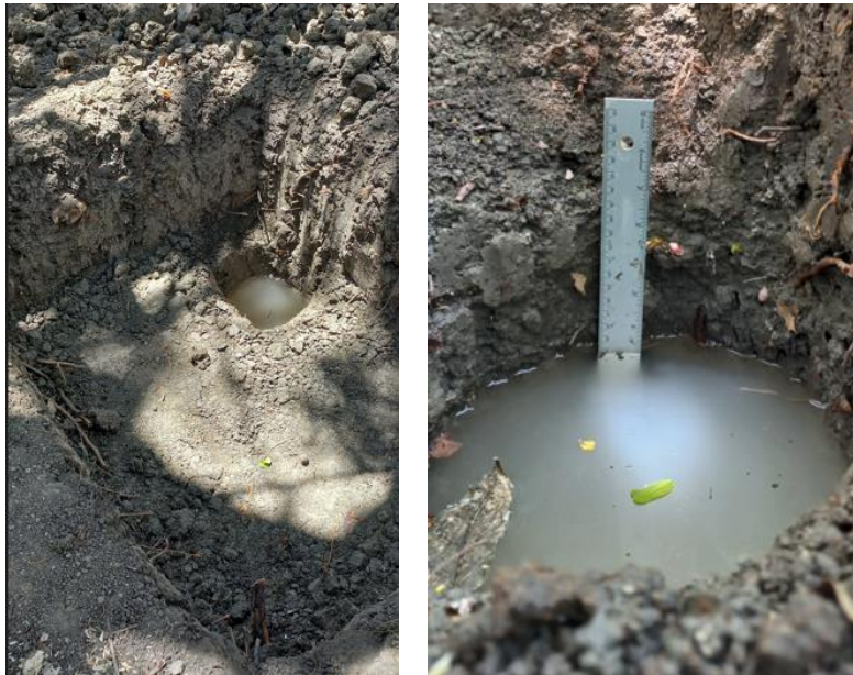
Figura 21. Pruebas de infiltración del suelo
