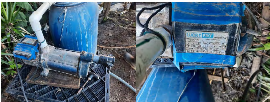
Figura 27. Bomba que se utiliza para la inyección del fertilizante en la tubería principal
