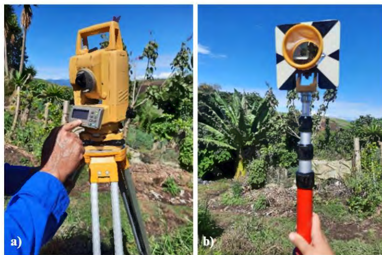
Figura 5. Estación total TOPCON que se utiliza en el levantamiento topográfico. b) Prisma de la estación total
