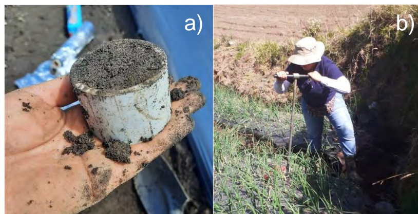
Figura 6. a) Cilindros que se utilizan para la recolección de muestras de conductividad eléctrica y densidad aparente. b) Recolección de muestras con barreno para textura y análisis químico del suelo
