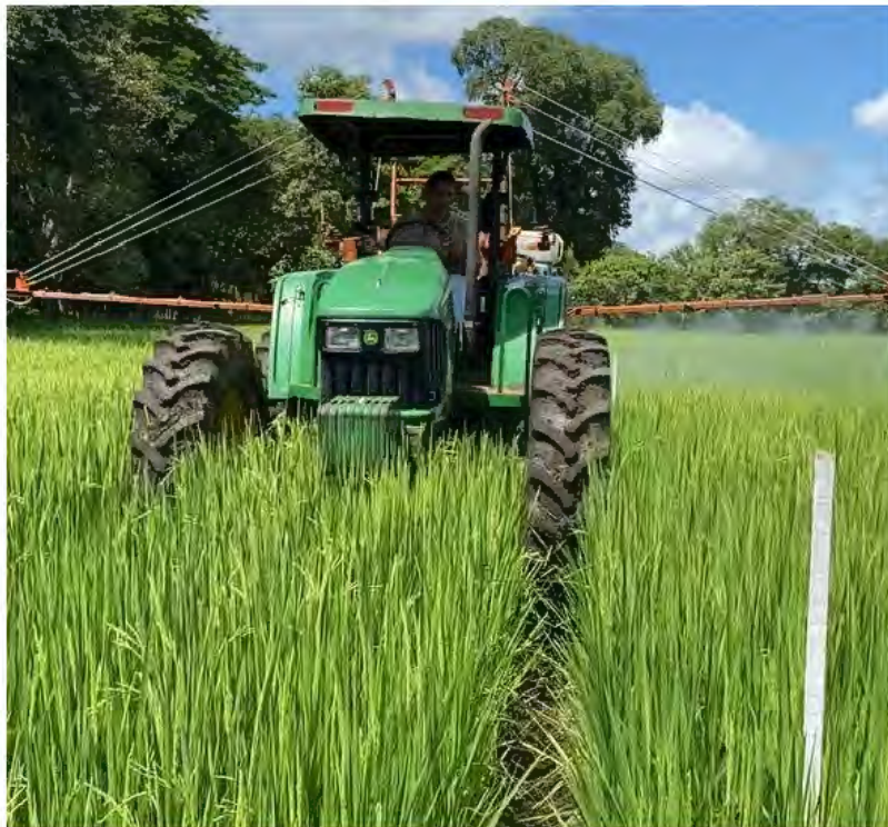
Figura 5. Tractor y spray boom utilizados durante aplicaciones líquidas
