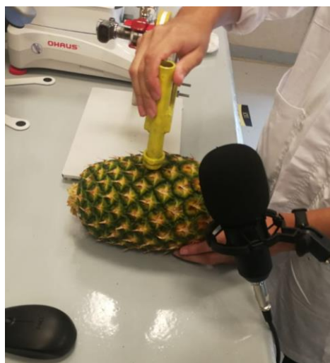
Figura 8. Ajuste de posición de muestra para prueba de impacto.
