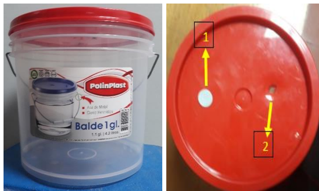
Figura 1. Recipiente plástico. 1) Entrada de aguja para toma de muestra de aire 2) Entrada de la boquilla de la bureta tipo jeringa. (Fuente: Autor)
