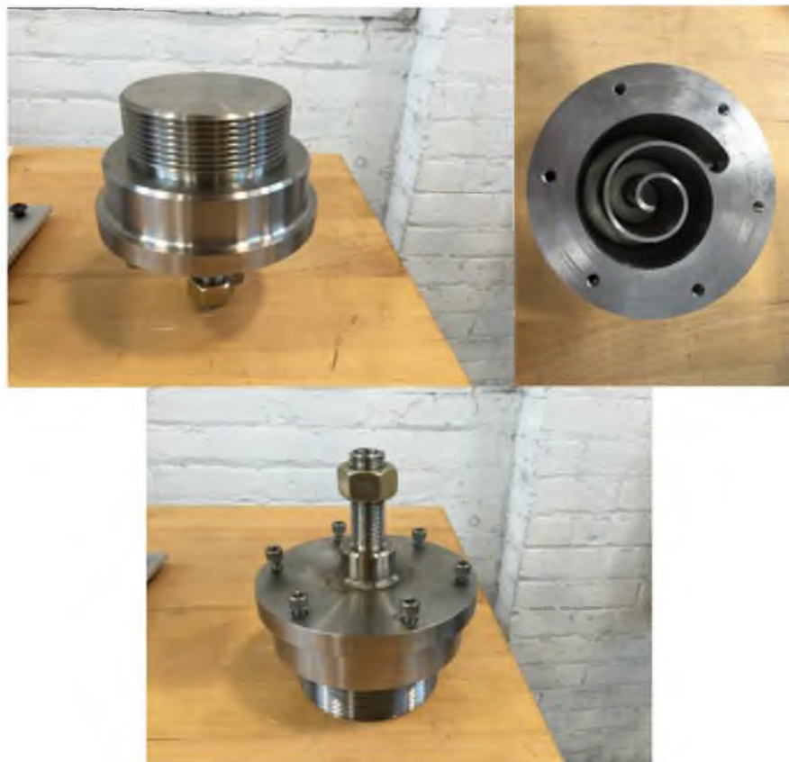
Figura 43. Absorbedor espiral, elemento construido.
