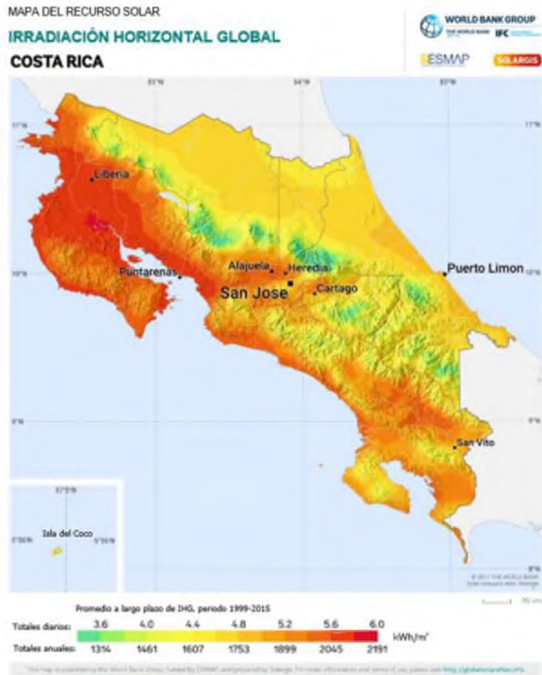
Figura 8. Irradiación horizontal global (GHI por sus siglas en inglés) en Costa Rica (13).
