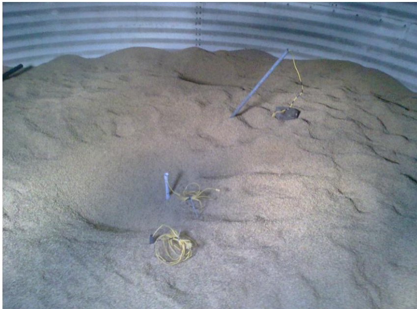
Figura 3.3 Ubicación de los termopares en la masa de grano
