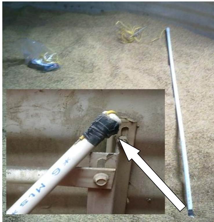
Figura 3.5 Colocación de los termopares en los tubos de PVC
