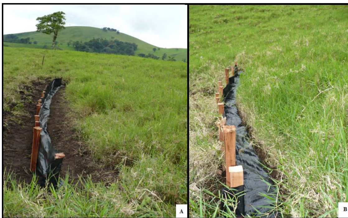
Figura 5.1 Ejemplo de parcela mal instalada, caso P 0-15 JJ. Fuente. El autor.
