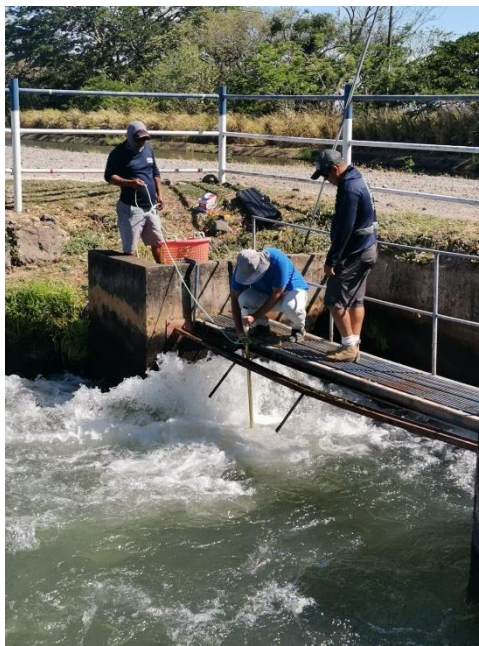
Figura 33. Zona preliminar donde se colocó el sensor (muy turbulenta).
