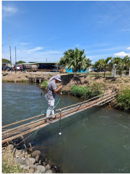
Figura 25. Medición de velocidad en el canal de la entrada principal.
