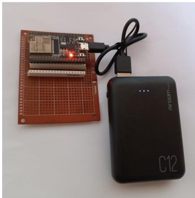
Figura 41. Montaje en físico del sensor a) montaje en placa del ESP32-WROOM-32U con el sensor ultrasónico US-100 y b) ESP32 conectado a la batería de respaldo.
