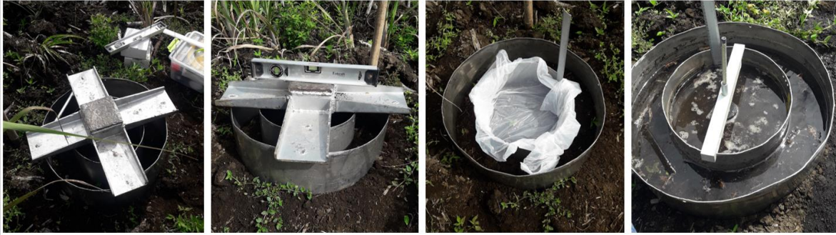
Figura 11. Instalación del infiltómetro de doble anillo en campo.
