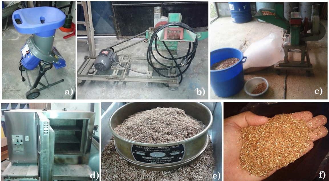
Figura 3.3. Equipo empleado para el pretratamiento de la biomasa. a) Trituradora b) Molino c) Molienda d) Horno e) Tamiz f) Residuo pre-tratado
