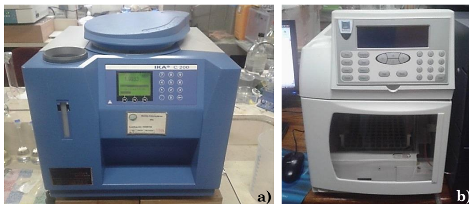
Figura 3.10. Equipo empleado para determinar el contenido de azufre y cloro. a) Bomba de combustión b) Cromatógrafo
